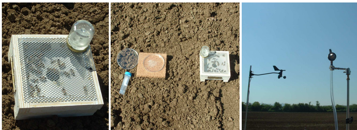
Figura 9 – Da sinistra: gabbietta con alimentatore, contenente circa 30 api; gabbietta a terra accanto ad una piastra Petri nel corso di una delle prove di semina; anemometro che rileva direzione e velocità del vento e capsula del campionatore d'aria contenente il filtro.
