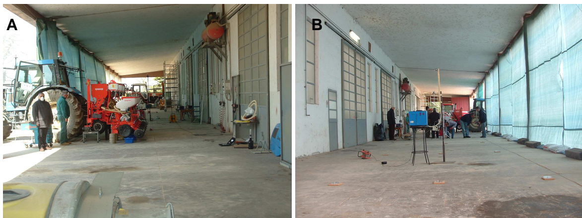
Figura 4 – Zona di prova a punto fisso. A) è visibile la seminatrice sollevata da terra e nell’angolo in basso a sinistra l’atomizzatore utilizzato per generare il vento; B) nella vista dal fondo sono visibili le piastre Petri e i campionatori d’aria alle varie distanze.
